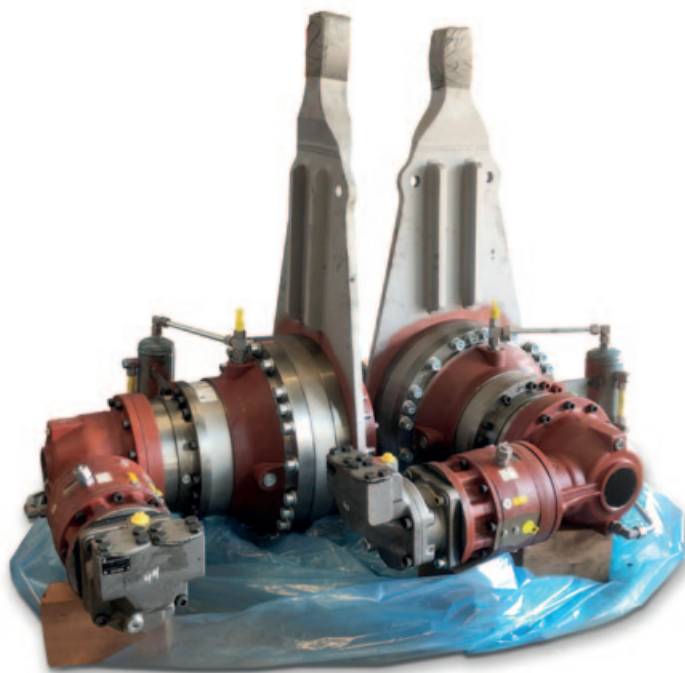
De Graaf Aandrijvingen leverde de spudpaalaandrijving voor De Schelde, bestaande uit planetaire tandwielkasten, hydraulische motoren en rondsels
